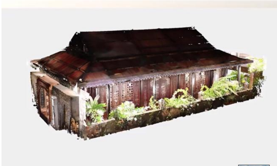
Mô hình 3D công ngôi nhà cổ 143 tuổi sau khi xử lý từ dữ liệu quét Laser Scan 3D Faro Focus S350A PORTCOAST
